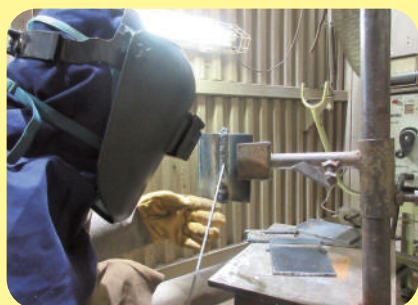
Soldagem eletrodo revestido
